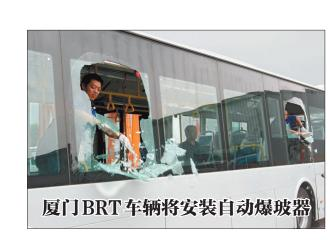
6月11日,工作人员演示车辆自动爆玻器的使用效果。厦 门将对全市BRT车辆(快速公交)安装自动爆玻器,以提高车辆 安全性能。自动爆玻器是在车窗上安装自动击打玻璃爆裂装 置,以使客车在遭遇火灾、恐怖袭击等紧急情况下,车内人员可 以从车窗快速逃生。 (新华社发)
