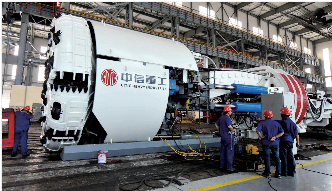
昨日,在中信重工装配现场,工作人员正在对直径5米开敞式硬岩掘进机进行总装调试
