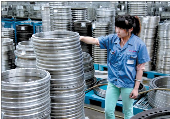
洛阳鸿元轴承科技有限公司轴承生产车间里,工人们正在检测精密转台轴承产品
