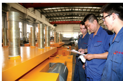
即将发货的锁定减隔震支座
