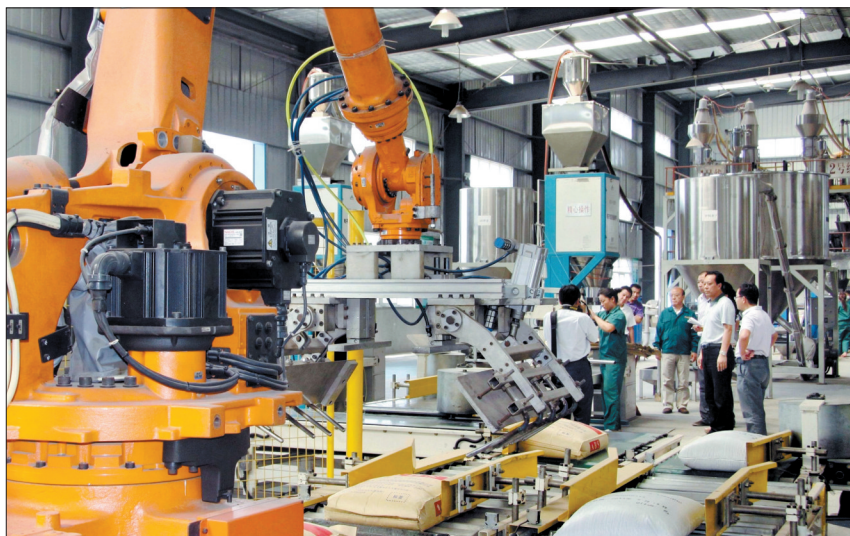
工作在废旧塑料深加工生产线上的“码垛机器人”
