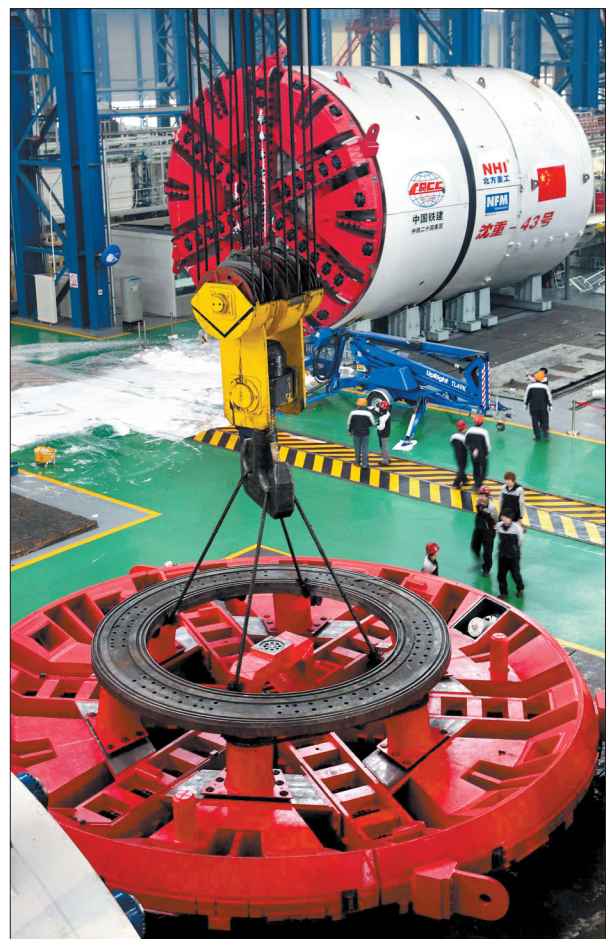
北方重工依靠自主创新,抢占装备制造业高地。图为大型盾构机安装现场
