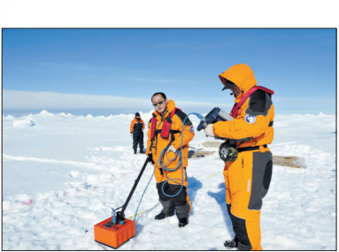
1月2日,中国工作组队员查恩来(右)和连震(中)在用冰雷达勘测海冰
