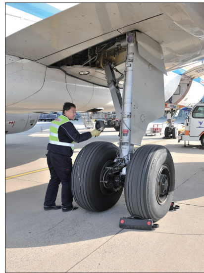
安装防静电设备
