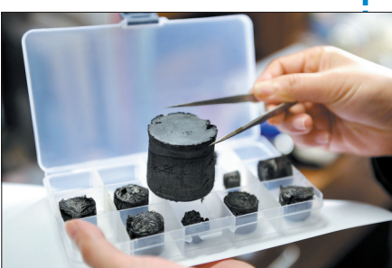
▲2013年3月19日,浙江大学高分子科学与工程学系高超教授展示制造出的“全碳气凝胶”固态材料。这种材料密度仅每立方厘米0.16毫克,是迄今为止世界上最轻的材料
