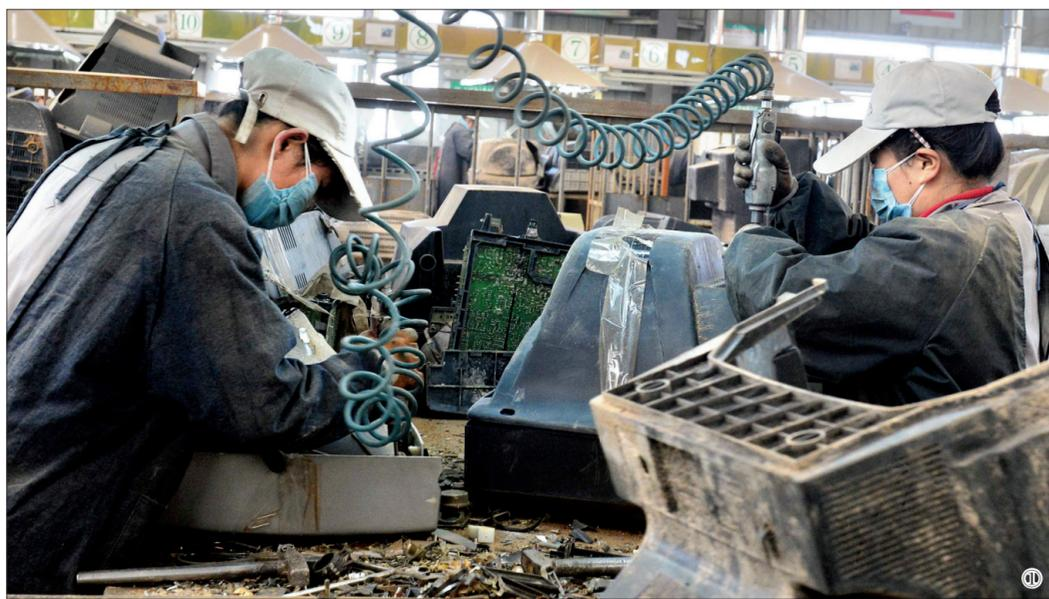
对于旧家电,一般人的处理方法是将其送到废品回收站,但很少有人知道旧家电是如何被拆解,又如何被加工并被合理利用的。春节刚过,记者在位于孟津县年处理295万台旧家电的河南省唯一的旧家电拆解项目——中再生洛阳投资开发有限公司旧家电拆解基地现场,目睹了旧家电拆解再加工的全部流程。从事这一行业的人被称为“城市矿产”的挖掘者。经过他们的手,一台旧电视、旧冰箱等旧家电,成功变身成铁、铜、塑料等原材料。
