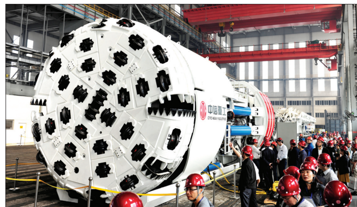
世界首台5米敞式无轨运输硬岩掘进机成功试车
