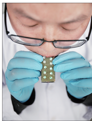
这款摩擦发电装置,只要对着吹气,就会有电流产生,使灯亮起
