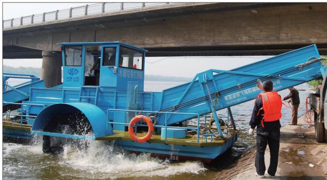
昨日,在洛阳桥上,不少人驻足停留,他们被洛水水面上一个掀起阵阵浪花并“吞食”垃圾的“大家伙”所吸引。原来,这个“大家伙”是近日在洛河市区段投用的水面垃圾打捞船,是目前我市水面保洁领域最先进的设备。市水务局河渠管理处相关负责人介绍,该船于去年年底从江苏购进,属国内一流,长15.8米、宽4.9米,可装载杂物6吨。该船前后有两个集物舱,作业时通过前方
