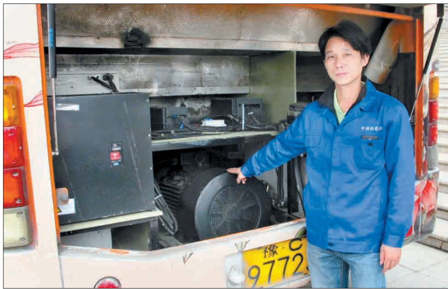
工人所指处为经过改造后新安装的电机,由电池给电机提供能源,电机驱动整车
