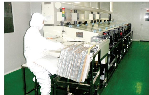
玻璃镀膜前的清洗作业
