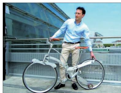
意大利发明家吉昂卢卡·萨达最新设计一款无辐条的“超级折叠自行车”(上图),它有66厘米直径的车轮,折叠之后的厚度仅与雨伞相近,可放入背包之中。人们完成简单的操作便能将这款自行车折叠起来。
