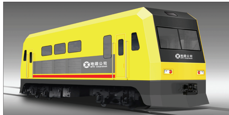
公司正在制造的香港地铁钢轨探伤车设计图
