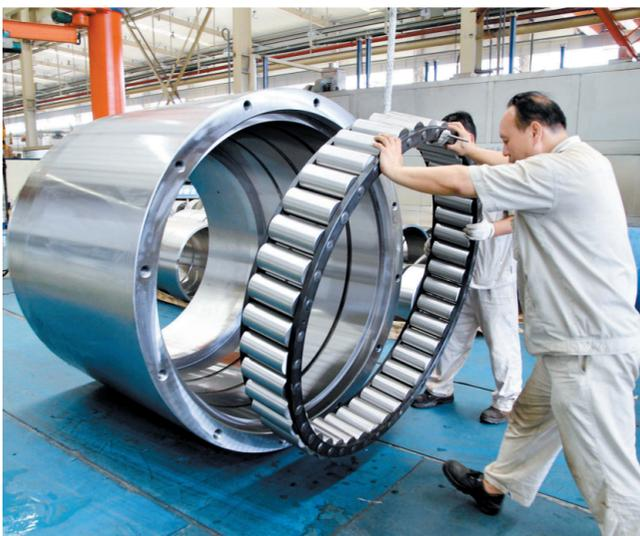
LYC公司研制出国内结构最复杂、精度极高的轧机轴承 首席记者 赵志伟 摄
