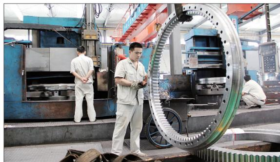
近日,在洛阳新强联回转支承股份有限公司,年产500套2.5兆瓦风力发电三排滚子主轴承项目部分设备已安装完毕,正在进行最后调试。作为新安确定的2014年十大工业项目之一,年产500套2.5兆瓦风力发电三排滚子主轴承项目建成后,年可创产值2亿元,实现利税2969万元,安置就业100人。左小雷 摄
