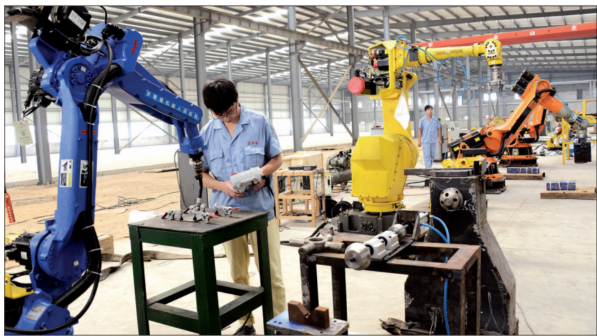
洛阳沃德福公司6轴工业机器人研发及产业化项目厂房内,机器人样机正在进行模具试焊接
