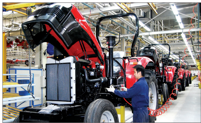
东方红动力换挡拖拉机总装线
