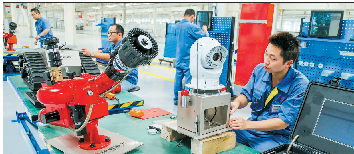
在中信重工特种机器人基地,工作人员正在装配调试消防机器人(本报资料图片)
