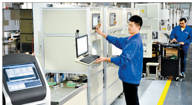
近日,在洛阳机器人智能装备产业园洛阳开远智能装备有限公司生产车间,技术人员正在调试汽车离合器分离轴承智能装配检测线。
