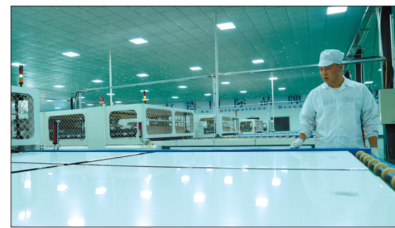
工作人员正在焊接太阳能电池板
