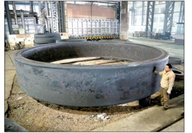
打造“大国重器”,再有“洛阳制造”建功!日前,洛阳新强联回转支承股份有限公司全资子公司洛阳圣久锻件有限公司,为汕头苏埃通道工程直径15米国产盾构机研制的超大型关节轴承锻件下线(如图),其88吨的重量也刷新了国内重大精密辗扩环形锻件的纪录。
