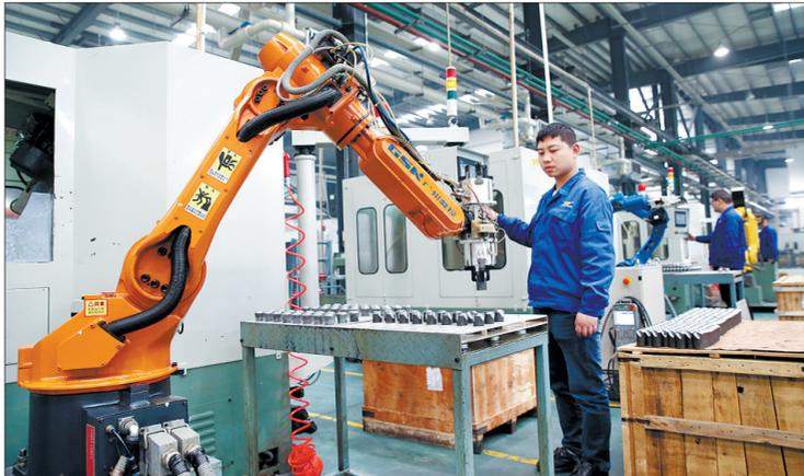
机器人正在加工硬质合金工具
