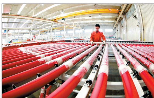
洛阳北方玻璃技术股份有限公司玻璃钢化连续炉生产线
