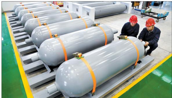
在双瑞特装生产车间,新一批核电用高压气瓶下线
