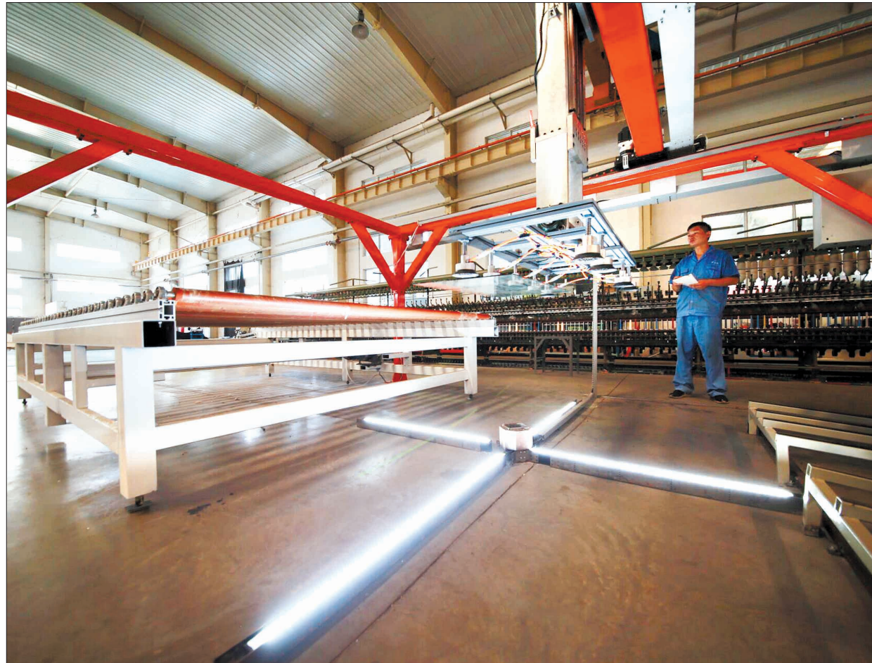
钢化炉智能摆片机器人在测量玻璃尺寸
