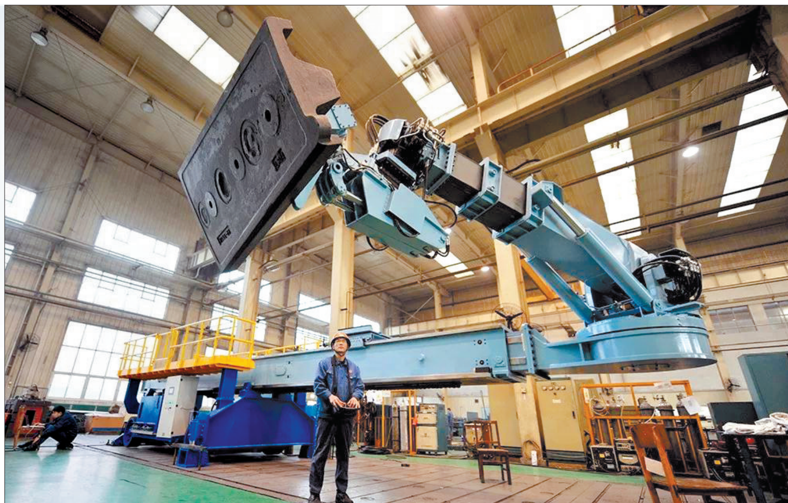
中信重工研发的重型磨板换衬智能机器人
