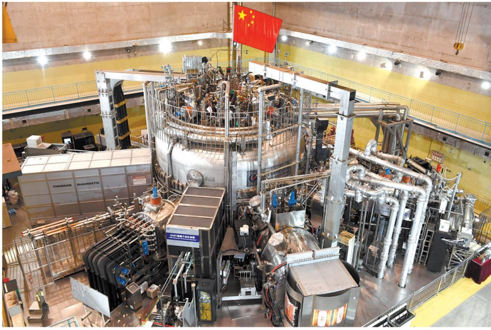
这是有“人造太阳”之称的全超导托卡马克大科学装置EAST。记者从中科院合肥物质科学研究院获悉,有“人造太阳”之称的全超导托卡马克大科学装置EAST近期实现1亿摄氏度等离子体运行等多项重大突破,获得的实验参数接近未来聚变堆稳态运行模式所需要的物理条件,朝着未来聚变堆实验运行迈出了关键一步。(新华社发)
