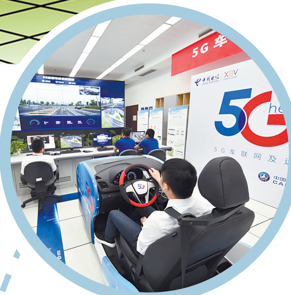
在中国汽车工程研究院实验室,技术人员坐在驾驶模拟舱利用5G远程驾驶系统控制汽车在城市道路上行驶
