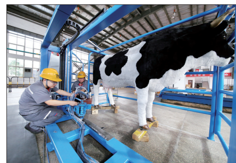
工人在调试挤奶机器人
