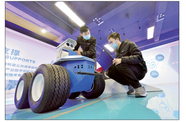
电力巡检智能机器人,洛阳造
