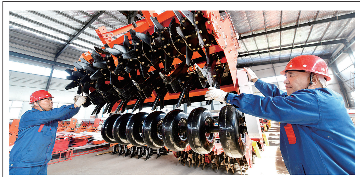
11月16日,在位于洛龙区白马寺镇的洛阳市鑫乐机械科技股份有限公司内,工作人员正在调试自主研发的智能全还田防缠绕免耕施肥播种机产品。这款智能播种机采用“播种云智能管理系统”,可使农户利用手机App操控,实现直观的智能精准控播,并根据云端信息运算结果,进一步提高播种效率。近年来,该公司不断加大智能化农机装备的研发和生产力度,加快实现农机信息化、智能化,打造智慧农业新高地,助力乡村振兴。记者 张光辉 通讯员 张俊强 张伊清 摄
