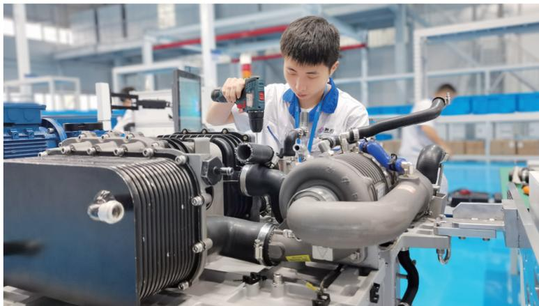
氢运新能源氢燃料电池系统生产线
