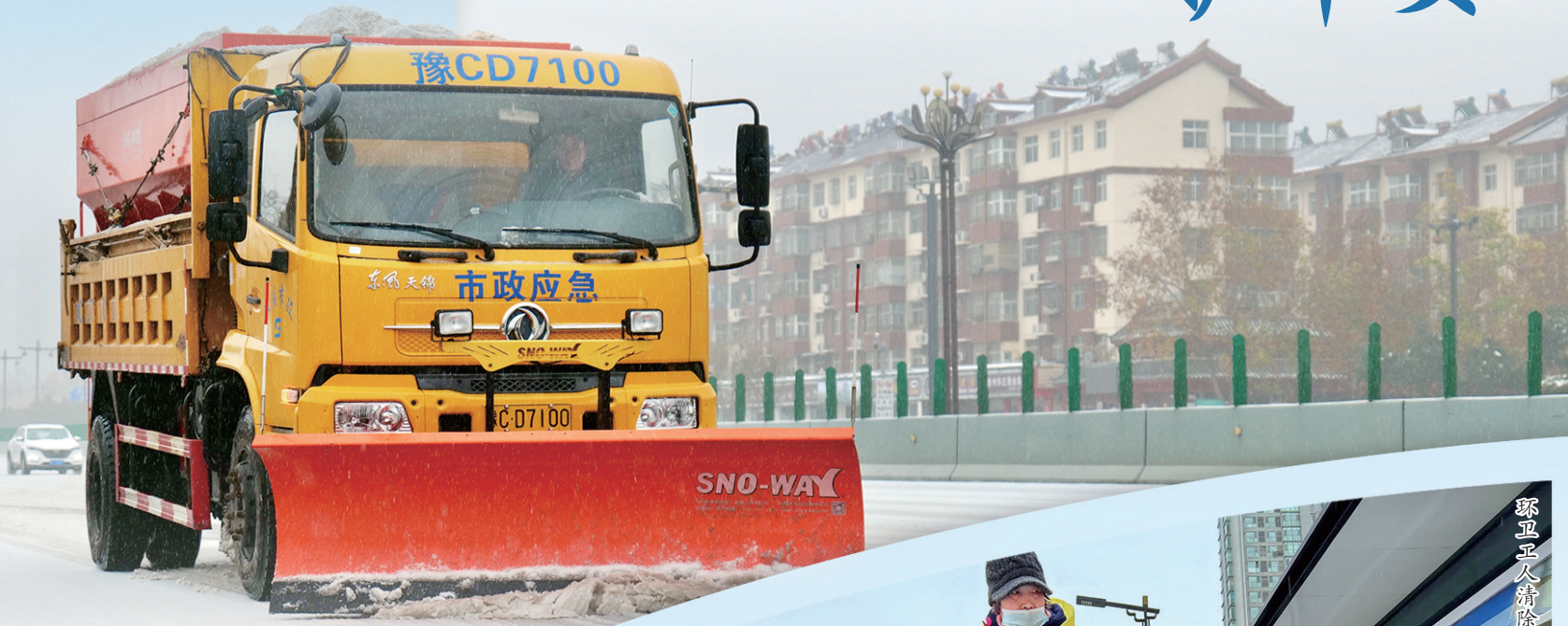
市政集团出动融雪剂撒布车清除桥面积雪
