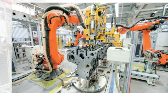
近日,在位于涧西区的中国一拖柴油机有限公司内,智能机械臂正在装配柴油发动机。
