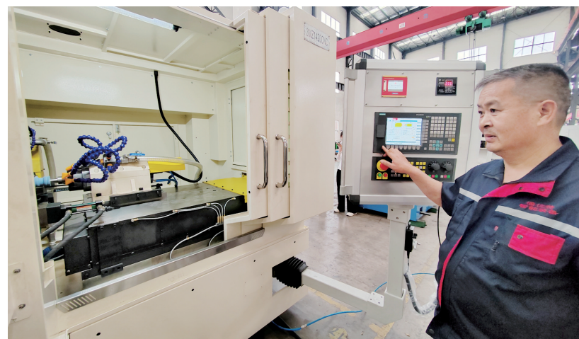
工人操作新能源汽车轮毂轴承试制磨削设备
