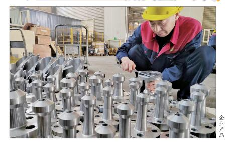
力大、腐蚀性高,具有高耐腐蚀、高疲 劳寿命等优点的钛合金油气管件产 品需求显著增长。然而,其制备工艺 曾长期受国外厂商制约,国产化一度 进展缓慢
