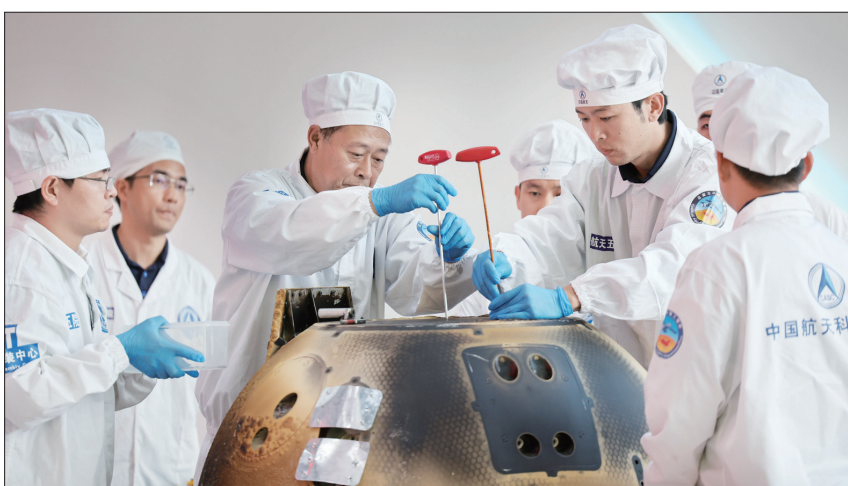
科研人员对嫦娥六号返回器进行开舱,检验关键技术指标完成情况(新华社发)
