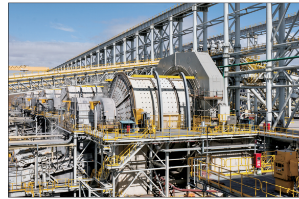
由中信重工研制的直径12.2米自磨机
