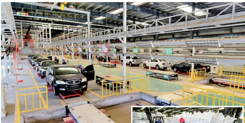
日前,在位于孟津区洛阳循环经济园区的中再生洛阳投资开发有限公司车间内,工作人员正在拆解一批回收的旧家电、报废汽车。其中,报废汽车拆解采用滑撬滚床流水模式,工位之间自动输送,有效提高工作效率。
